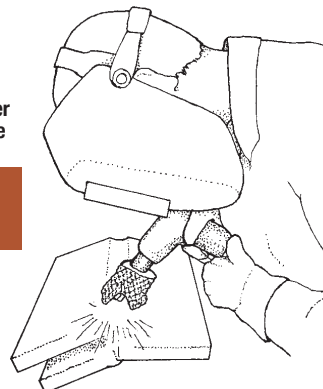
Installation d'un filet en acier inoxydable autour de la buse
