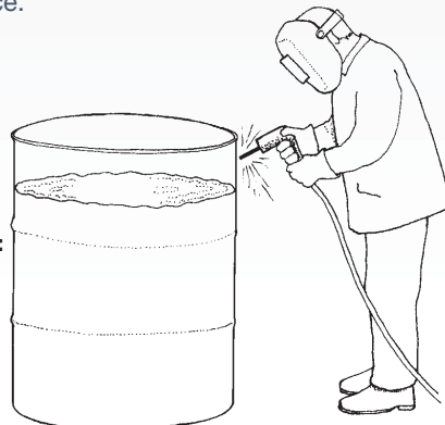
Remplissage d'un réservoir avec de l'eau : le niveau d'eau est sous la soudure.
